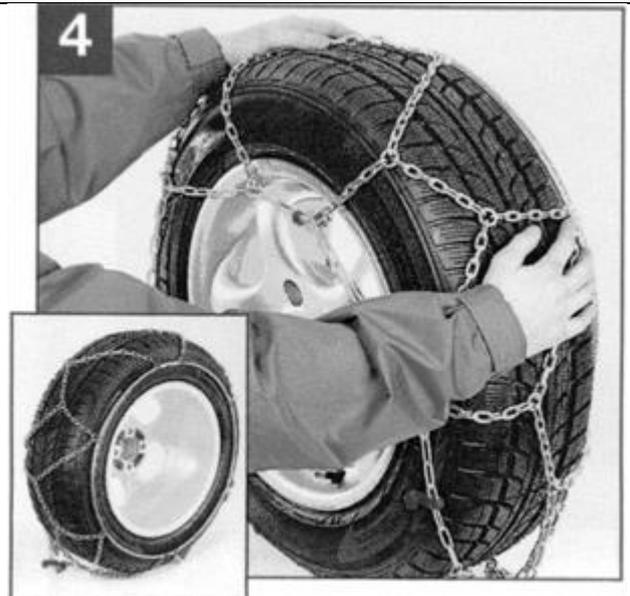
4. Завести тросовый обод за колесо, проверить, чтобы ни тросовый обод, ни замок не попадали на рабочую поверхность шины.
