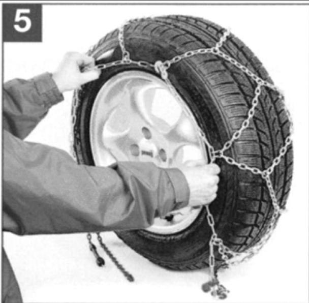
5. Расправить цепь на дорожке протектора. Следует обратить внимание на то, чтобы ни один отрезок цепи не был перекручен.
