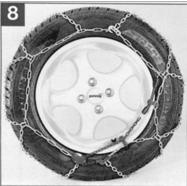
8. При долгой эксплуатации цепей, через первые 50 метров остановиться и проверить надежно ли натянуты цепи, при необходимости перецепить натяжную цепь. Снятие цепей производится в обратном порядке.
